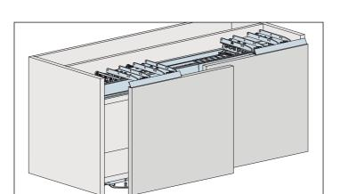
Sistema: Binario di scorrimento e di guida avvitati, a scorrimento superiore, senza lavorazione del mobile, per due ante in legno fino a 20 kg. Design a filo del piano/Forslide.
