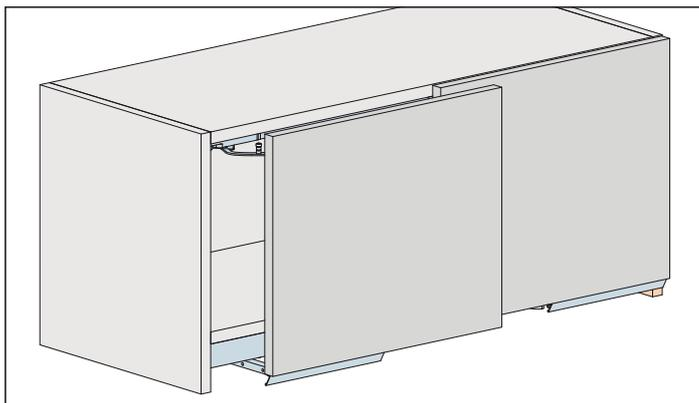
Sistema: Binario di scorrimento e di guida avvitati, a scorrimento inferiore, senza lavorazione del mobile, per due ante in legno fino a 20 kg. Design a filo del piano/Forslide.
