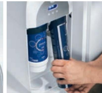
Schrauben Sie die CO<sub>2</sub>-Flasche ein und schließen Sie die Vorderseite mit der Abdeckung. Den Kühler für ungefähr 20 Minuten zum Runterkühlen des Wassers ruhen lassen.
