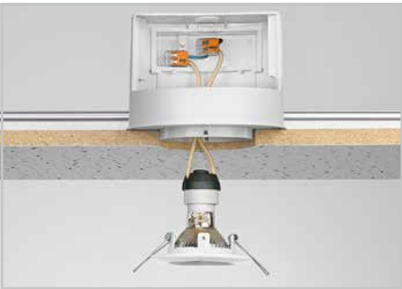
Individueller Aufbau von Niedervolt-Beleuchtungssystemen
