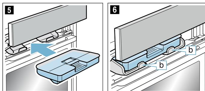
9. Blende langsam nach unten schieben, dann nach hinten drücken, bis sie vollständig geschlossen ist. Der Wassertank ist gefüllt. Sie können Betriebe mit Dampf starten.
