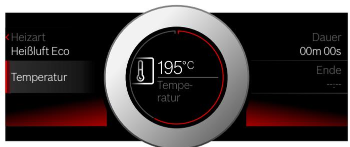
3. Mit Taste start/stop
