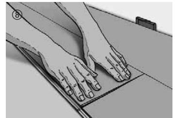
Anschließend wird das Element stirnseitig abgesenkt. Beachten Sie hierbei, dass das Element stirnseitig bündig an das zuvor verlegte Element anstößt. Durch kurzen Druck auf den Querstoß rastet das Element ein.
