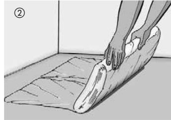
Grundsätzlich ist bei allen Estrichen und bei Verlegung auf Fußbodenheizung eine 0,2 mm starke PE-Folie auszulegen. Diese soll im Stoßbereich 30 cm überlappen. Anschließend die Folie im Wandbereich hochziehen und nach der Sockelleistenmontage an der Oberkante abtrennen. Da der Boden bereits eine integrierte Korkdämmunterlage besitzt, darf keine zusätzliche Dämmunterlage ausgelegt werden.
