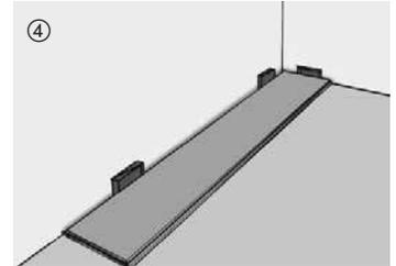
In der rechten Raumecke beginnend, werden die Elemente mit der Federseite zur Wand verlegt und mit Abstandskeilen fixiert (Dehnungsabstand zur Wand 10-15 mm).
