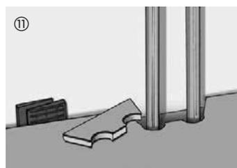
Für aus dem Boden herausragende Heizrohre werden in die Elemente Öffnungen (Größe abhängig vom jeweiligen Heizrohr und unter Berücksichtigung des erforderlichen Dehnungsabstandes) gebohrt oder gesägt.
