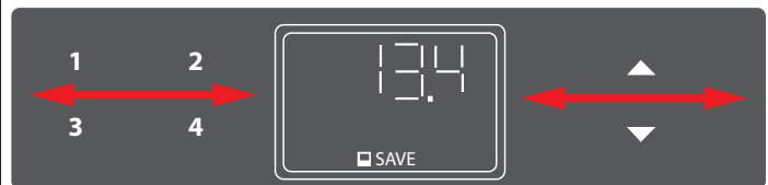
Abb. 48: Aktivierung und Deaktivierung der Sperre beim LegaDrive Touch Comfort Handschalter erfolgt durch Wischen nach links oder rechts
