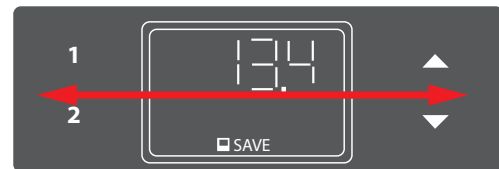
Abb. 49: Aktivierung und Deaktivierung der Sperre beim LegaDrive Touch Inlay Handschalter erfolgt durch Wischen nach links oder rechts
