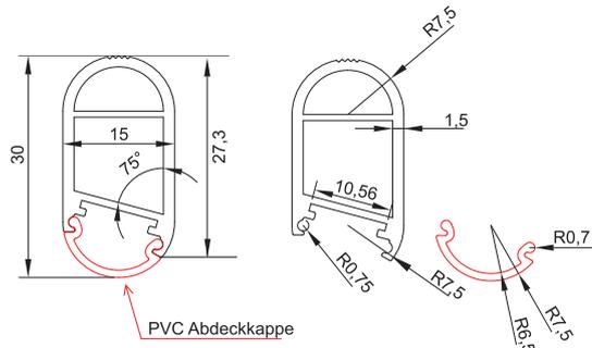
Das Set enthält ein Ledprofil mit dem Platz zur Befestigung des LED Bandes und einer Abdeckkappe (LED Band ist nicht in der Verpackung enthalten).
