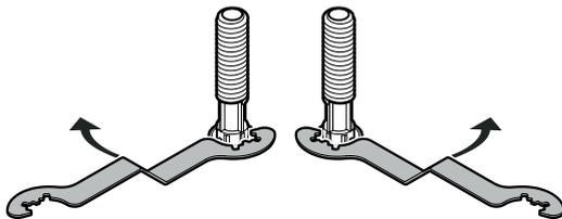
Den Schlüssel im Uhrzeigersinn drehen, um das Gerät anzuheben, und gegen den Uhrzeigersinn drehen, um es abzusenken.
