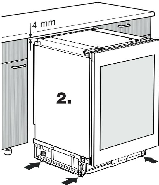
2. Das Gerät in der Höhe durch Drehen der Stellfüße im Uhrzeigersinn bis auf 4 mm unterhalb der Nischenhöhe einstellen.
