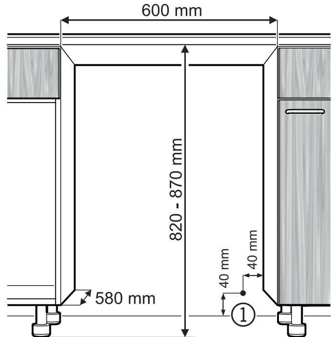
① In diesem Bereich kommt die Netzzuleitung aus der Rückseite des Gerätes.
