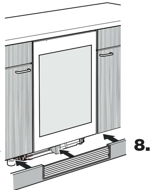
**8.** Sockelblende aufsetzen. Das Schaumformteil wird dabei nach hinten in seine endgültige Position verschoben.
