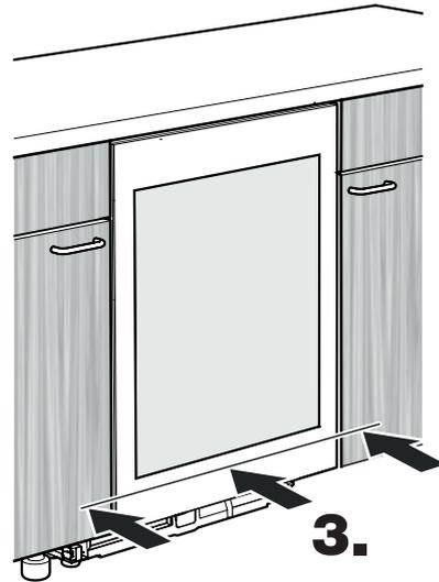
3. Das Gerät einschieben, bis die Vorderfläche der Gerätetür mit den Möbelfronten bündig ist.
