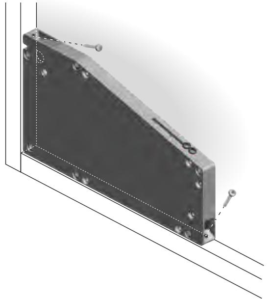
3 - Montaggio della guida cavo laterale
