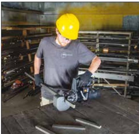
◀ Schnelles und einfaches Durchtrennen von Flachstäben mit den elektrischen Flachstangen-Schneidgeräten der EFBE-Serie
