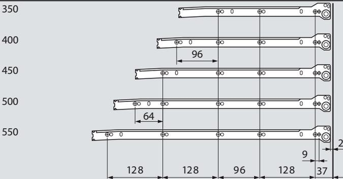
Dimensionamento per pannelli in truciolare da 16 mm
