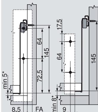
Quote foratura del frontale per montaggio EXPANDO e a pressione
