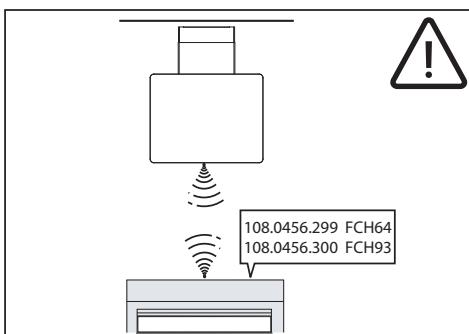
**Предупредување:** аспираторот може да се поврзе со плотните 108.0456.299 FCH64 и 108.0456.300 FCH93.
