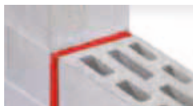
Spáry v masivní stěnové konstrukci
