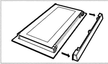
3. Entfernen Sie, wie in der Abbildung gezeigt, das innerste Glas (1), indem Sie es leicht in Richtung 'A' anheben und in Richtung 'B' herausziehen.
