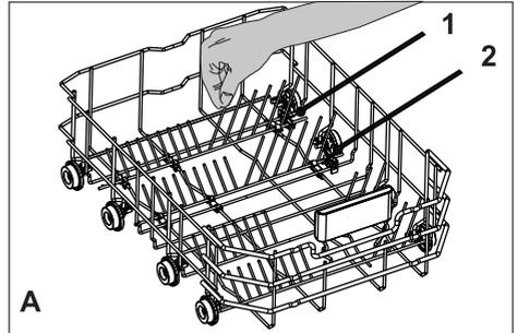
Um den Halter in eine horizontale Position zu bringen, in der Mitte fassen und in Pfeilrichtung (B) schieben. Halter zum Hochklappen einfach wieder in eine aufrechte Position bringen. Die Halter rasten selbsttätig ein.
