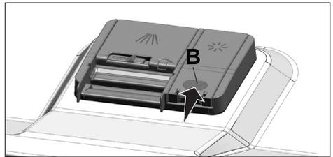
4. Falls nach dem Spülen Flecken am Geschirr verbleiben, stellen Sie eine höhere Stufe ein. Sollte eine bläuliche Färbung nach dem Abwischen des Geschirrs von Hand zurückbleiben, wählen Sie eine niedrigere Stufe. Ihr Gerät ist ab Werk auf Position 3 voreingestellt.
