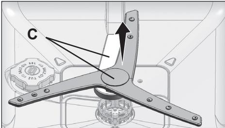
Zum Ausbauen und Reinigen der unteren Sprüharmbaugruppe halten Sie sie an den in der Abbildung gezeigten Punkte (C) mit einer Hand fest und ziehen Sie sie nach oben. Montieren Sie die Teile nach der
