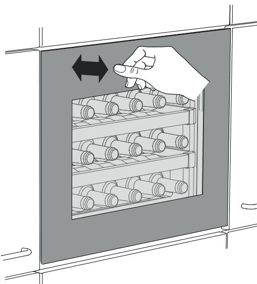
Dvere sa otvoria pomocou posuvnej tyče o cca 5 cm.
