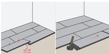
**ERSTE REIHE:** Beginnen Sie mit der Verlegung in einer rechten Raumecke. Legen Sie die erste Diele so, dass die Federseite zur Wand zeigt. Richten Sie diese mit Abstandskeilen exakt aus. Die zweite Diele legen Sie knapp vor die erste Diele und klopfen diese mittels Schlagklotz und Hammer zusammen. Achten Sie dabei, dass die
