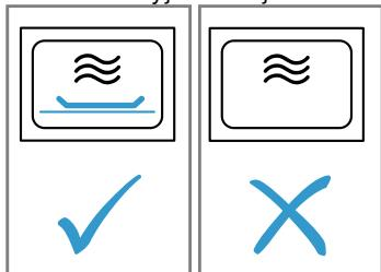
Při vícenásobně bezprostředně opakované přípravě popcornu v mikrovlnné troubě pomocí příliš vysokého výkonu mikrovlnného ohřevu může dojít k poškození pečicího prostoru.
