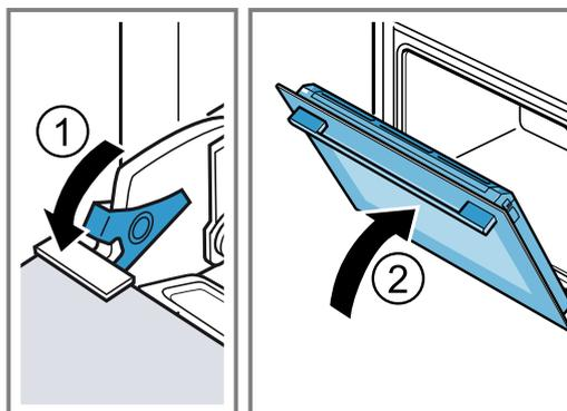
4. Die Türabdeckung links und rechts von außen drücken ①, bis sie ausrastet.
