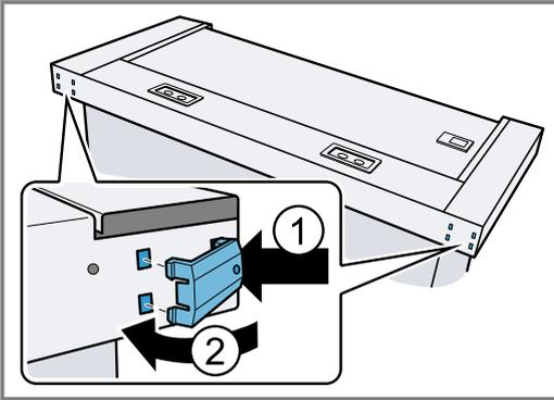
2. Die Griffleiste mit den beiliegenden Schrauben am Filterauszug befestigen.
