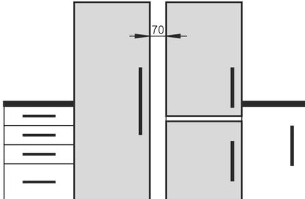
Wird dieser Abstand nicht eingehalten, so bildet sich Kondenswasser zwischen den Seitenwänden der Geräte.
