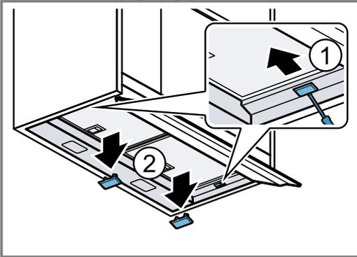
9. Die Schienen abschrauben und falls verwendet, die Montagehilfen abschrauben.
