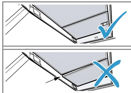
6. Sicherstellen, dass die Verriegelungen einrasten.
