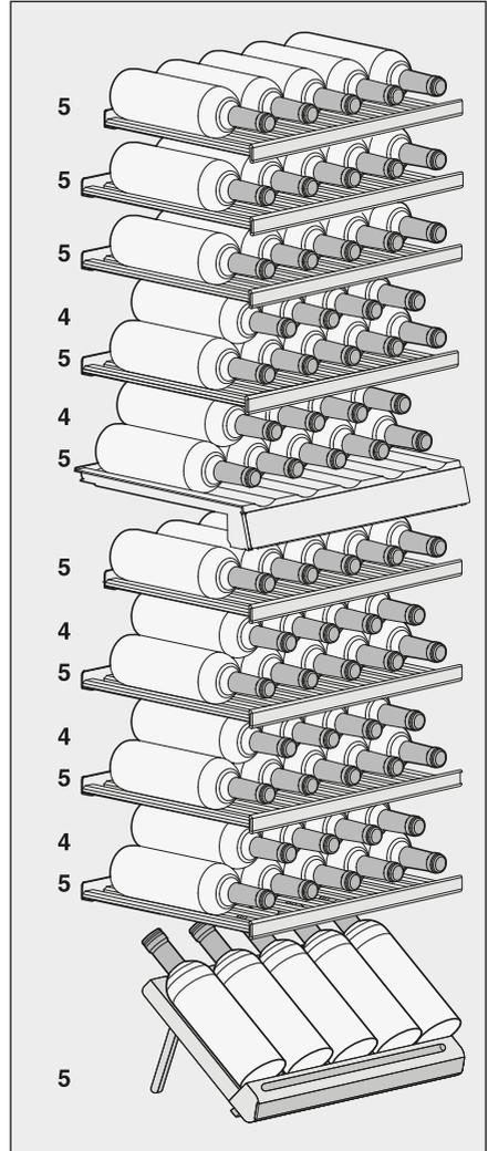
Mit aufgestelltem 3D-Bodenpräsentier können maximal **70 Flaschen** (0,75 l; Flaschenform: Bordeauxflasche) im Weinschrank gelagert werden, und zwar 33 Flaschen in der oberen Zone und 37 Flaschen in der unteren Zone.
