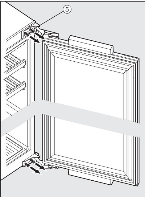
■ Drehen Sie die unteren und oberen Schrauben ein Stück aus den Scharnieren ⑤ heraus. Die Gerätetür muss währenddessen von einer weiteren Person festgehalten werden.
