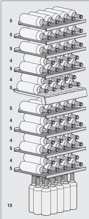
Bei entnommenem 3D-Bodenpräsentier können maximal **80 Flaschen** (0,75 l; Flaschenform: Bordeauxflasche) im Weinschrank gelagert werden, und zwar 33 Flaschen in der oberen Zone und 47 Flaschen in der unteren Zone.
