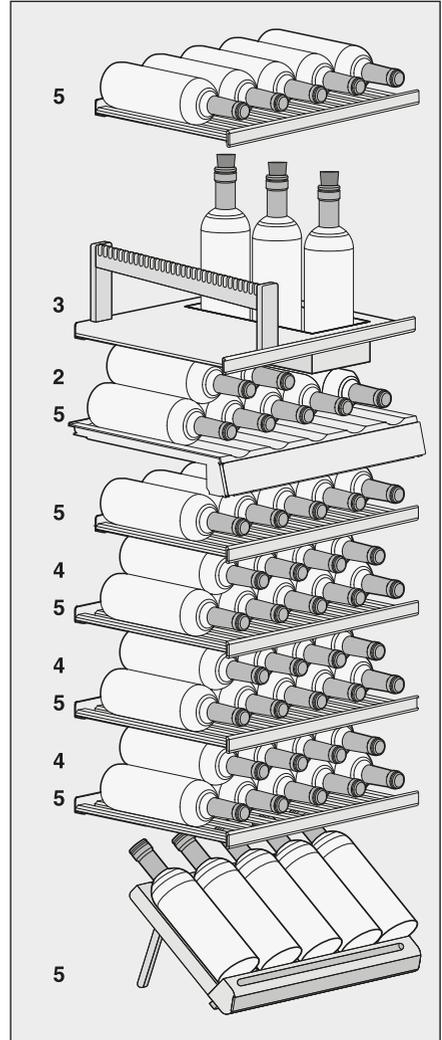
Mit aufgestelltem 3D-Bodenpräsentier können maximal **52 Flaschen** (0,75 l; Flaschenform: Bordeauxflasche) im Weinschrank gelagert werden, und zwar 15 Flaschen in der oberen Zone und 37 Flaschen in der unteren Zone.
