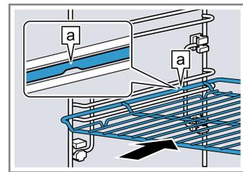
Blech z. B. Universalpfanne oder Backblech Das Blech mit der Abschrägung
