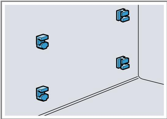
1. Die vorderen Halterungen mit dem Haken oben in das runde Loch einfädeln und etwas schräg stellen ①.
