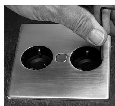
Über die Schrauben (Innensechskant) die Flügel an der Unterseite der DUPLEX fixieren. Nun kann die DUPLEX angeschlossen/ eingesteckt werden. Bei Knopfdruck öffnet und schließt die DUPLEX elektrisch.
