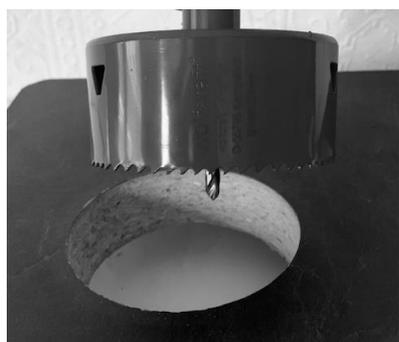
Lochsäge mit  $\varnothing$  105mm
