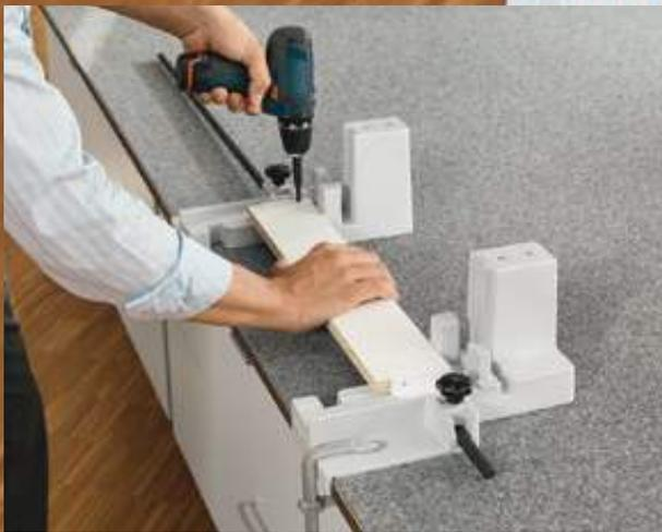
Holzrückwand und Rückwandhalter können spaltfrei und präzise verschraubt werden.
