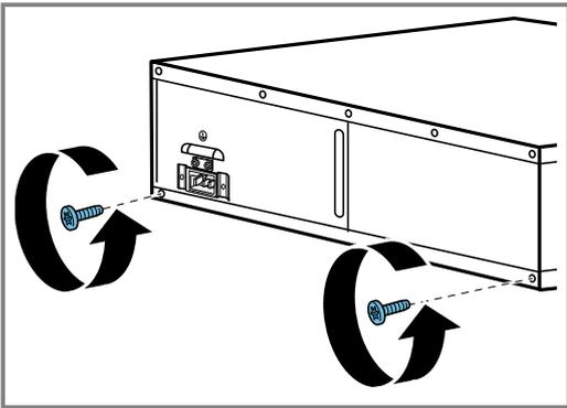
5. Die beiden Metallhalter an der Gerätrückseite mit den beiden Schrauben festschrauben.
