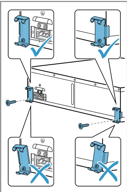
6. Das Gerät in das Einbaumöbel einschieben und prüfen, ob der Kippschutz einrastet.
