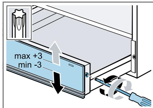
3. Die Gerätefront nach oben oder unten ausrichten. Maximal sind -3 bis +3 mm Ausrichtung möglich.
