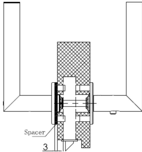
Wenn der Abstand vom Schlosskasten zum Rosettenboden weniger als 10 mm beträgt, muss eine Unterlegplatte hinzugefügt werden.
