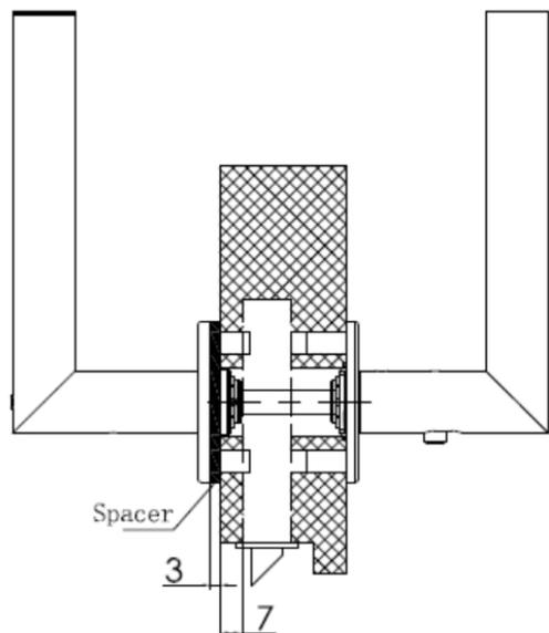
Wenn der Abstand vom Schlosskasten zum Rosettenboden weniger als 10 mm beträgt, muss eine Unterlegplatte hinzugefügt werden.
