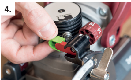
4. P- System Tiefenstelleraufsatz 4 mm aufstecken (effektive Frästiefe 8 mm)
