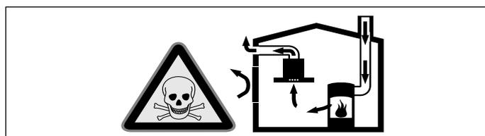
I focolari che dipendono dall'aria ambiente (peres. a gas, olio, legna o carbone, scaldabagno, caldaie elettriche) ricavano l'aria per la combustione dalla stanza ed eliminano i gas di scarico all'esterno attraverso un impianto (peres. camino). In concomitanza della cappa accesa, dalla cucina e dalle stanze adiacenti viene sottratta dell'aria: senza un'alimentazione sufficiente di aria si crea depressione. I gas velenosi dal camino o dalla cappa di aspirazione vengono riaspirati nelle stanze.
