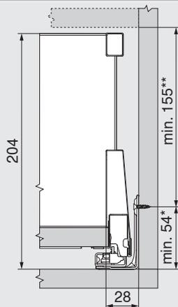
\* + 1 mm in caso di montaggio della guida fianco prima di assemblare il corpo mobile
