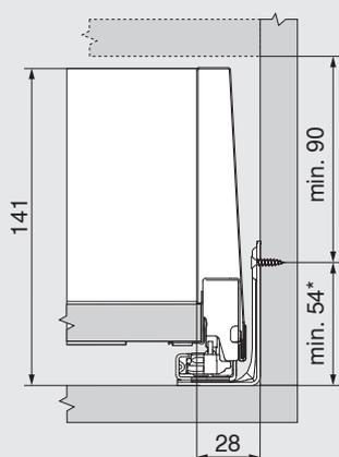
\* + 1 mm in caso di montaggio della guida fianco prima di assemblare il corpo mobile
