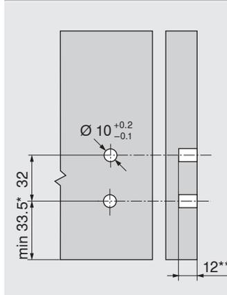
\* + 1 mm in caso di montaggio della guida
