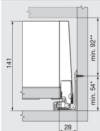
\* + 1 mm in caso di montaggio della guida fianco prima di assemblare il corpo mobile
