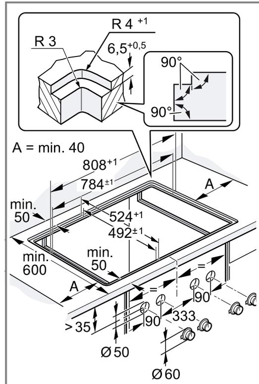
5. Sicherstellen, dass der Winkel der Schnittfläche zur Arbeitsplatte 90° beträgt.
