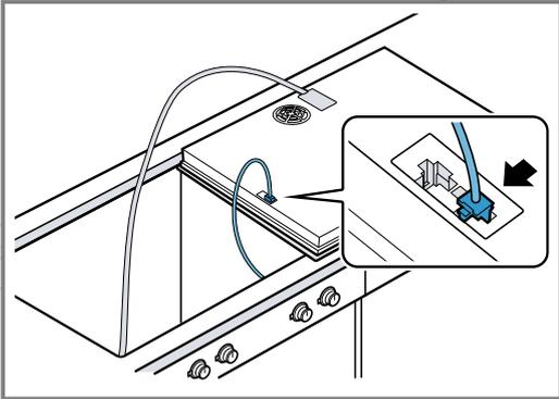
2. Sicherstellen, dass der Stecker in die Buchse einrastet.
