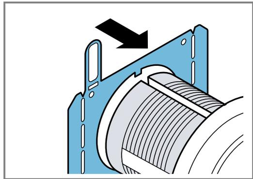
8. An der Rückseite des Bedienknebels die Haltemutter mit dem beiliegenden Montagewerkzeug festschrauben.
