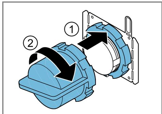
9. Den Bedienknebel exakt in Nullstellung ausrichten.
