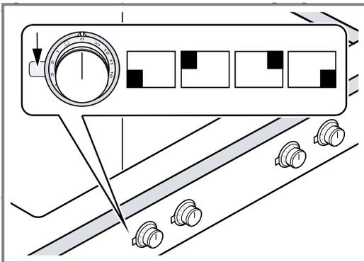
6. Den Bedienknebel in die Bohrung stecken.
