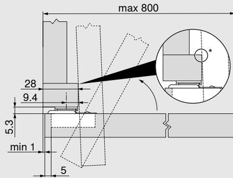
Scharniermaße und Fugenberechnung bei Werkseinstellung
