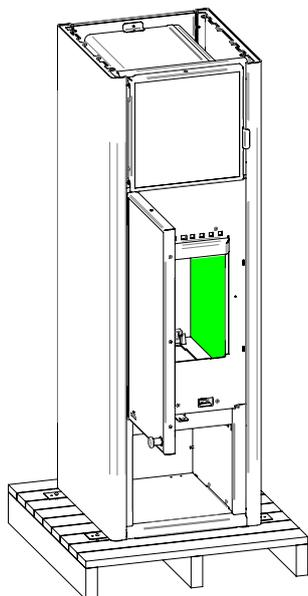
Feuerraumplatte rechts einsetzen.
