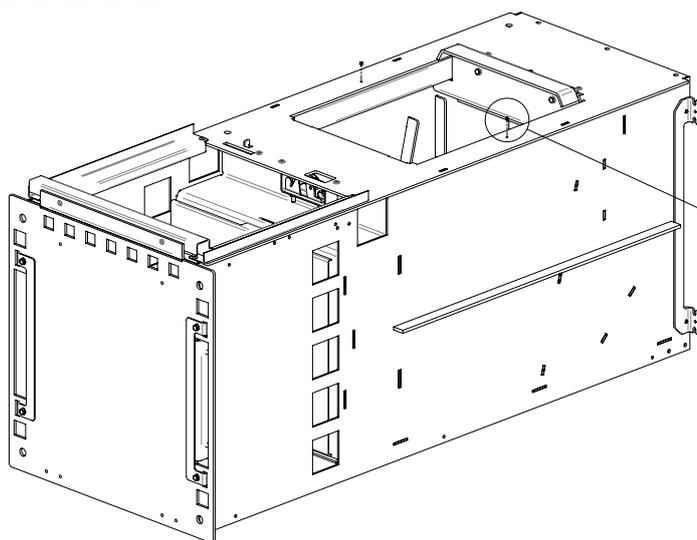
2x Madenschraube bis auf Anschlag eindrehen und festziehen.
