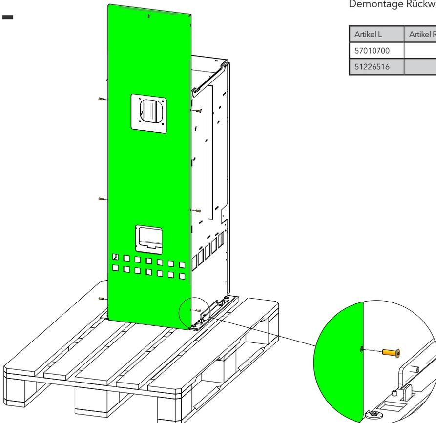
Demontage Rückwand und sichere Ablage.
