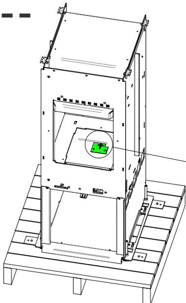
Luftschieberstange und Luftschieberplatte mit Splint verbinden und Enden aufbiegen.
