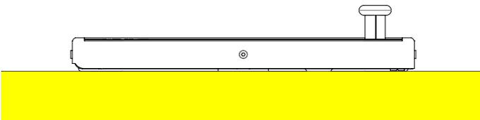
Zwischenlagerung auf Dichtschnur, damit sich diese dem flachen Untergrund anpasst und angedrückt wird.
