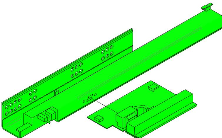
Tip-On links und rechts bei Schubladenführung einklinken.
