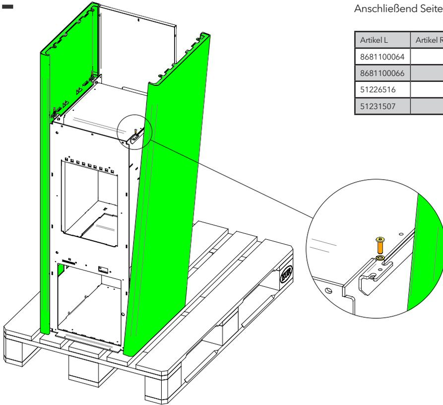
Demontage Seitenwände und sichere Ablage.
