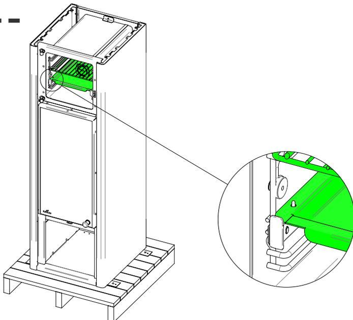
Backblech, Grillrost und Thermometer in Backrohr geben und Führung mit Karton oder Klebeband sichern.
