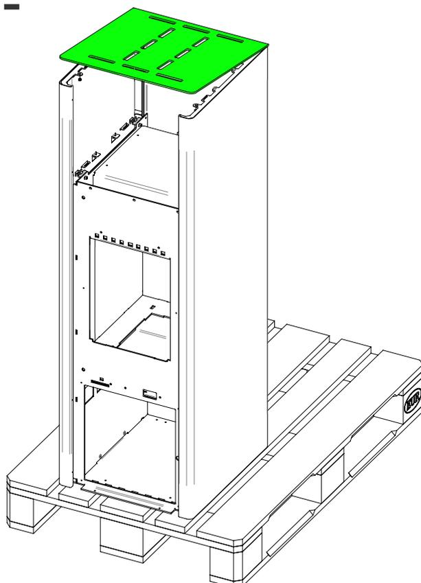
Demontage Abdeckung und sichere Ablage.
