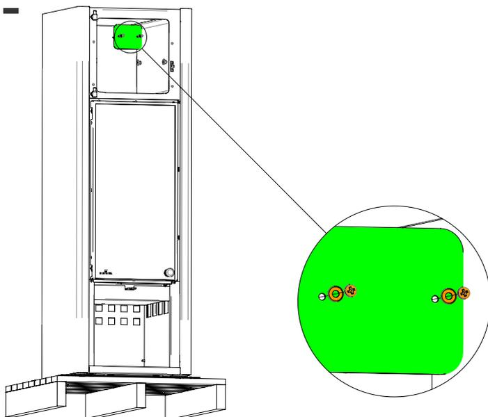
2x Blindeckel mit Backrohr verschrauben.
