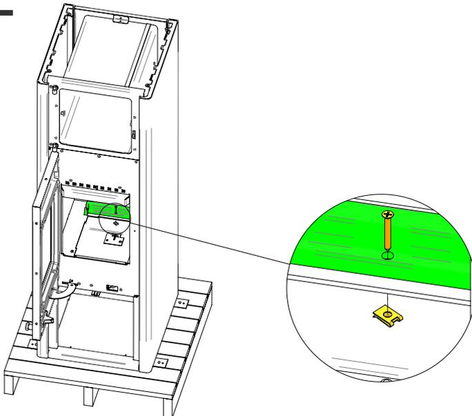
1x Lager auf Boden montieren.
