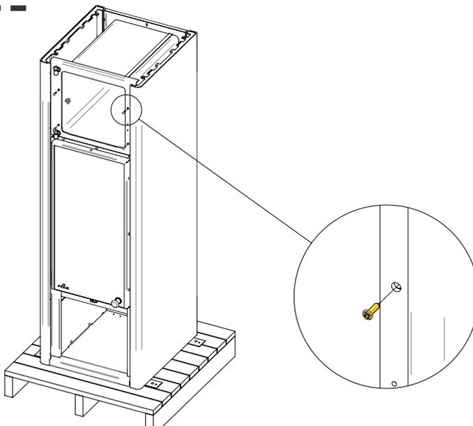
4x Front mit Backrohr verschrauben.
