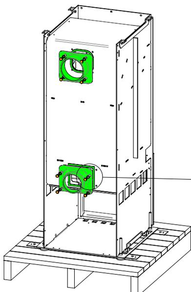
Stützen trennen und Silcafelt umlaufend aufkleben.
