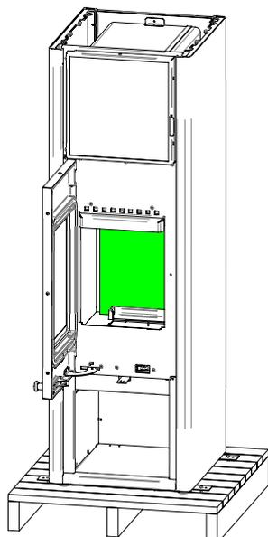
Feuerraumplatte hinten einsetzen.
