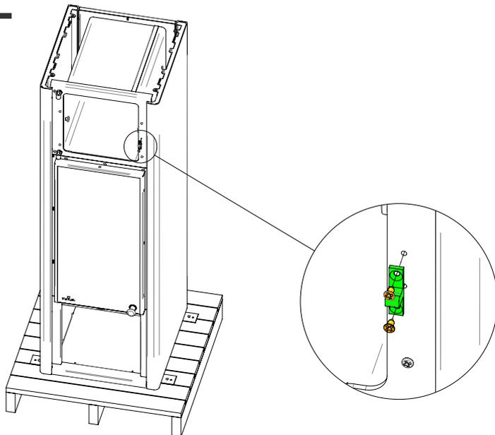
2x Kugelschnapper-Zapfenstück auf Front montieren.
