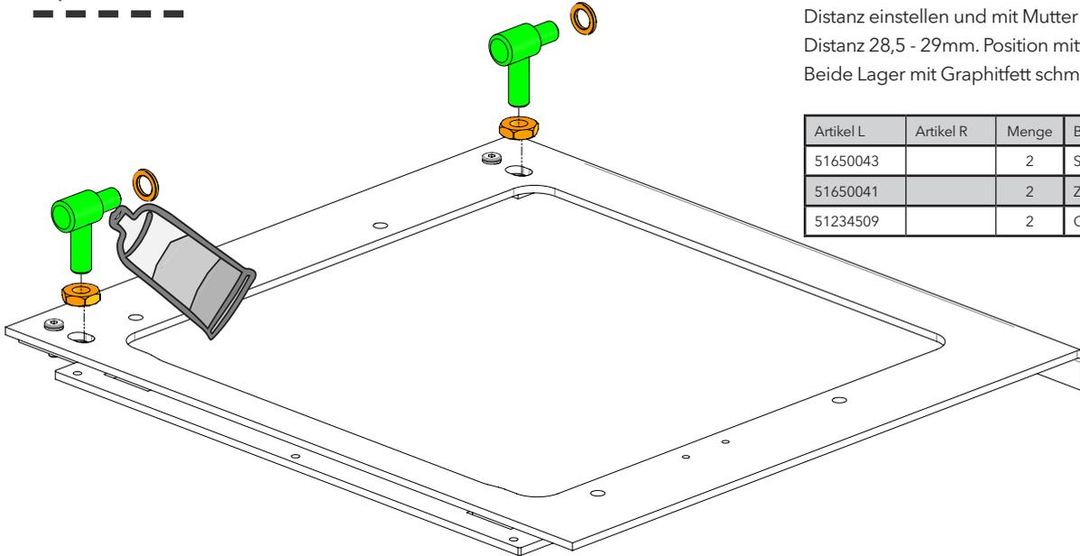
2x Stahlzargenband einschrauben und Ring aufsetzen.
