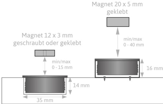
**MAGNET EINBAU & AUFBAU MONTAGE**
