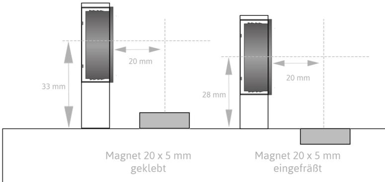
*Für individuelle Montage- bzw. Sonderlösungen empfehlen wir eine manuelle Ermittlung des Distanzbereichs zwischen Magnet und Magnetsensor um eine optimale Funktionalität zu gewährleisten.*
