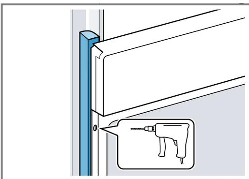
**3. Gerät mit adäquater Schraube befestigen.**
