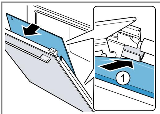
2. **Hinweis:** Die Zwischenscheibe positioniert sich automatisch durch die Drehbewegung der Abstandshalterung.
