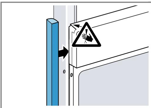
2. Aluprofile vorbohren, um eine Schraubverbindung herzustellen.
