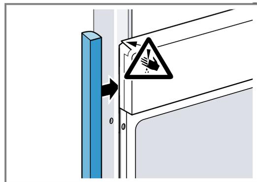
2. Aluprofile vorbohren, um eine Schraubverbindung herzustellen.
