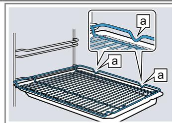
Rost Den Rost mit der offenen Seite zur Gerätetür einschieben.
