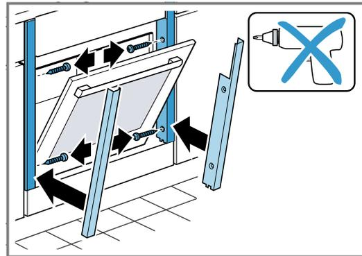
**Hinweis:** Der Spalt zwischen Arbeitsplatte und Gerät darf nicht durch zusätzliche Leisten verschlossen werden.
