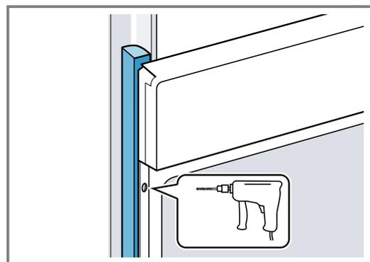
3. Gerät mit adäquater Schraube befestigen.
