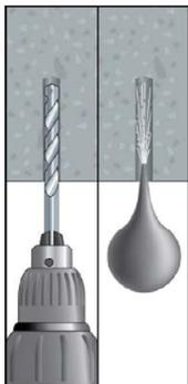
1. Bohrloch mit Hammerbohren erstellen, Bohrloch reinigen (ausblasen).
