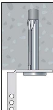
4. Der Deckenanker DA ist installiert. Geringes Nachjustieren bzw. Drehen des
