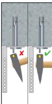
3. Anker von Hand bzw. durch leichte Hammerschläge weiter ins Bohrloch
