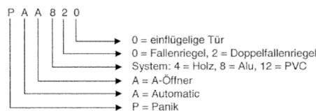
Die Schlosstypen PA 400 – 1220, GU-SECURY Automatic-DRP und Security 1910 - 1971 können mit autarker Zusatzfalle am Langstulp in Kombination mit Fluchttüröffner EFF-EFF 332 als elektrisch verriegeltes Panikschloss (Security EVP) betrieben werden. Die Panikfunktion ist nur bei freigeschaltetem (spannungslos) Türöffner EFF-EFF 332 gewährleistet. (Dann nur VS-TYP B)
