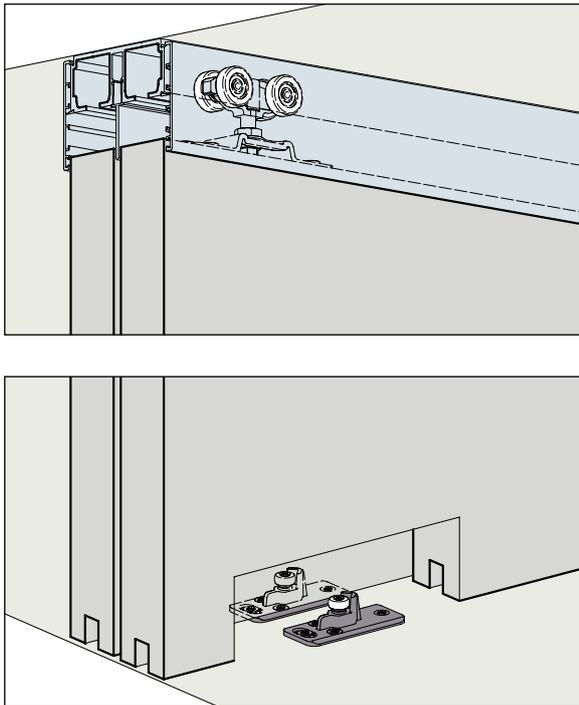
System: Laufschiene obenlaufend, Wand- oder Deckenmontage, für Holztüren bis 100 kg
