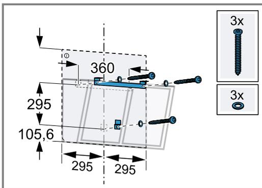
3. Die beiliegenden Schrauben in die obere Geräteaufhängung vollständig eindrehen.
