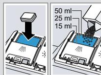
2. Den Deckel der Reinigerkammer schließen.
