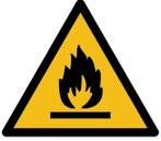
► **Warnung: Brandgefahr/brennbare Materialien.** Dieses Symbol befindet sich auf dem Kompressor und weist auf brennbare Materialien hin. Entfernen Sie diesen Aufkleber nicht.
