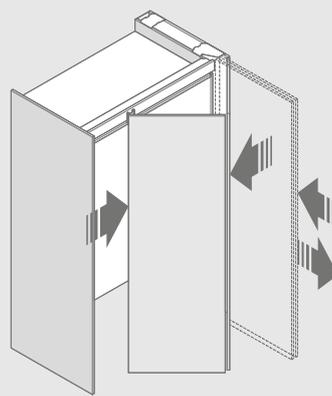
Zur Simulation von Überbelastung beim Öffnen und Schließen und zur Absicherung gegen das Herunterfallen der Fronten.
