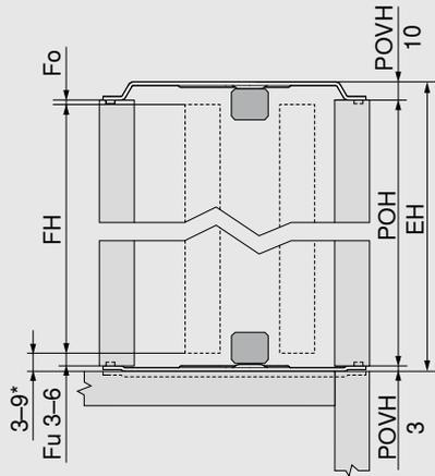
\* Bei Abstand der Front zum nächsten darunterliegenden Element < 6 mm ist der Pocketverbinder in die Arbeitsplatte einzulassen
