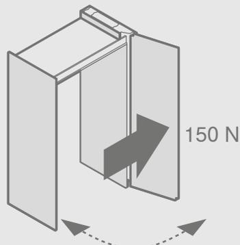
Horizontale Belastungsprüfung zur Absicherung der unbeabsichtigten Überbelastung
