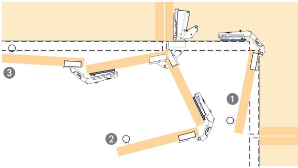
Bei Beginn der Schwenkbewegung öffnet sich das Türelement an der Griffseite um ca. 50 Grad.
