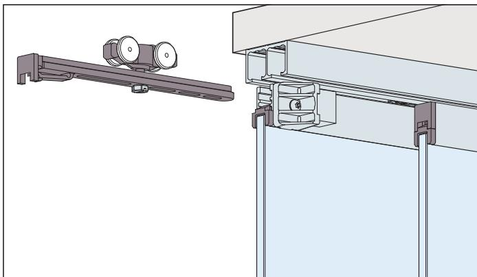
System: Laufschiene eingenutet oder aufgeschraubt,
